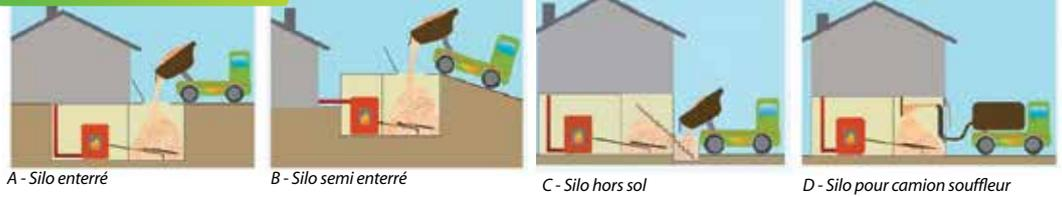
principalement par camion souffleur (schéma D), ce qui permet de livrer des silos difficilement accessibles. Cependant, la longueur maximale entre le camion souffleur et le stockage ne doit pas dépasser 25 mètres. Le plus souvent, un local reconverti en stockage peut suffire pour accueillir le combustible et permet de limiter les coûts liés au gros-œuvre.
